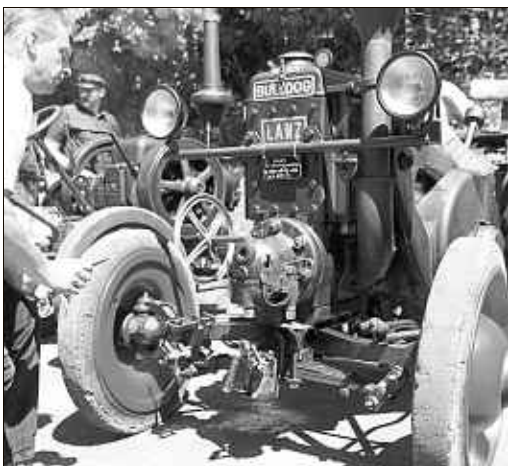
Der Glühkopf-Lanz auf Vollgummireifen wird mit Feuer und dem Handrad angeworfen.
